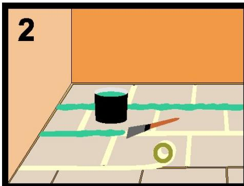
Při lepení na dřevěné a objemově nestale podklady musí být lepicí tmel dostatečně flexibilní. Pro tento účel doporučujeme použít F-board 10. U těchto podkladů doporučujeme desky kotvit nejméně 4 kotvami osazenými min. 30 mm od hrany
