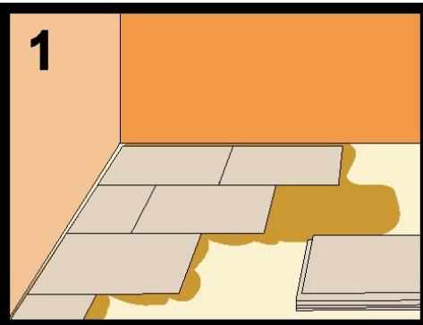
Rozneste zubovou stěrkou lepicí tmel na cementové bázi. Desky pokládejte dle obrázku 1, důkladně usaďte a vyrovnejte. Lepící hmotu nechte vytvrdnout dle návodu k použití. Při pokládce nesmí lepicí hmota pronikat do spár mezi deskami. Dilatační spáry v podkladu musí být zachovány.
