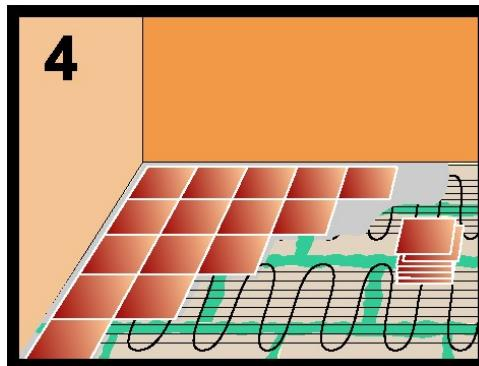
Položte rohož dle požadované vytápěné plochy. Na topnou rohož naneste vrstvu flexibilního tmelu a položte dlažbu. Při pokládce musí být dodrženy podmínky návodu k topným rohožím (kabelům). Dilatační spáry konečných povrchových úprav se nesmí krýt se spárami desek F-board. Podkladové dilatační spáry musí být zachovány.
