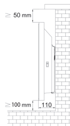
Obrázek 9. Odstupové vzdálenosti po instalaci
