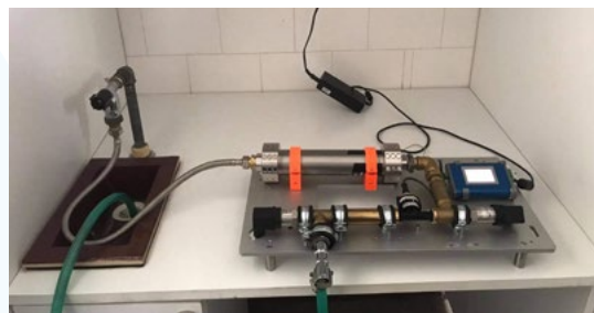
Zařízení vyvinuté výzkumníky pro měření účinku vody upravené IPS na růst rostlin při různých tlacích.
